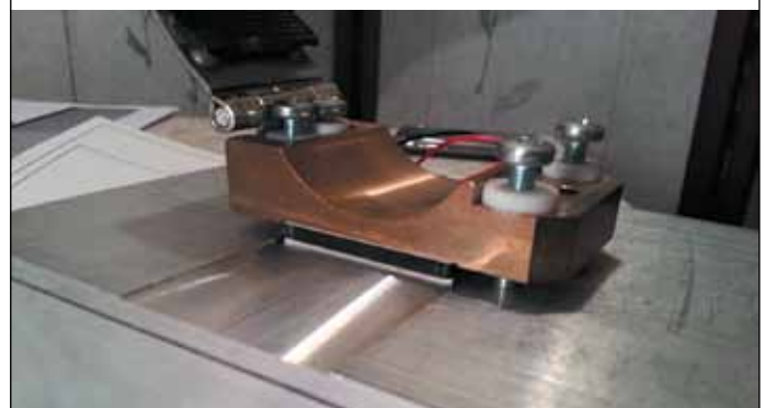
Рис. 9. Конструкция термоэлектрического генератора: 1 — теплоъемник; 2 — хомут для крепления генератора на трубе; 3 — ТГМ; 4 — радиатор
